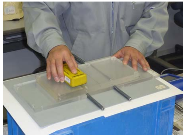
写真3 走査方向の分解能の検証状況
