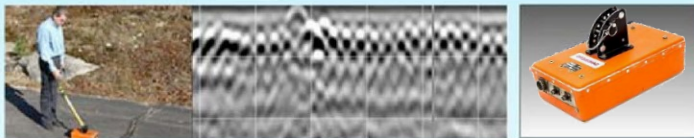
900MHz アンテナ 鉄筋・埋設配管探査、躯体厚調査/探査深度 700mm
