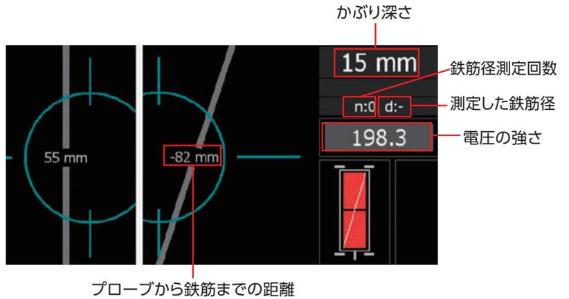
プローブから鉄筋までの距離
