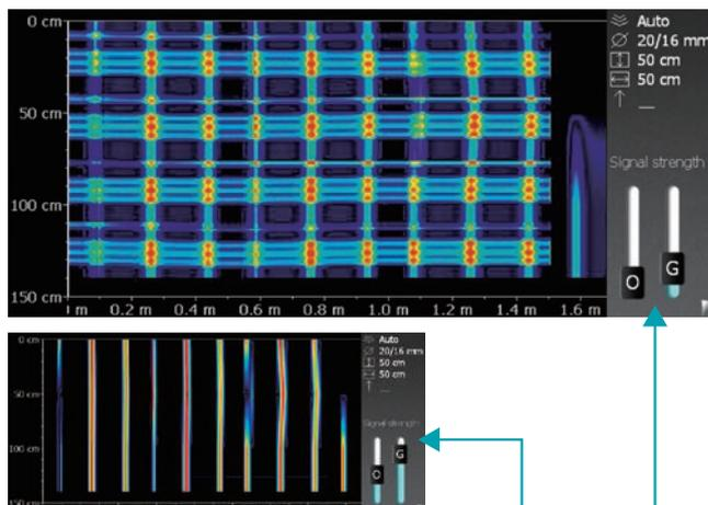
オフセットおよびゲインスライダの位置を変更して信号強度範囲および解像度を設定し、カラースペクトルに表示することで、第一層の鉄筋のみを表示することができます。
