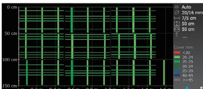
画面をタップして、かぶり厚さ、直径、信号強度ビューを切り替えます。
