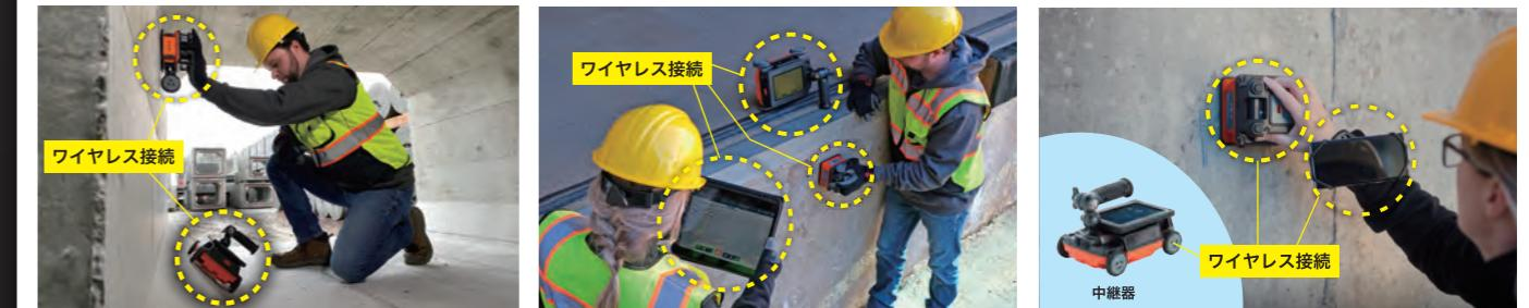
従来有線接続だったストラクチャスキャンシリーズですが、Flexシリーズは、ワイヤレス接続を採用！それにより、遠隔探査ができるようになりました、探査範囲も大幅に拡大。探査現場・使用ユーザーに適した探査方式に変更することが可能となりました。
