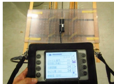
アクリル板の間にラス網を配置
