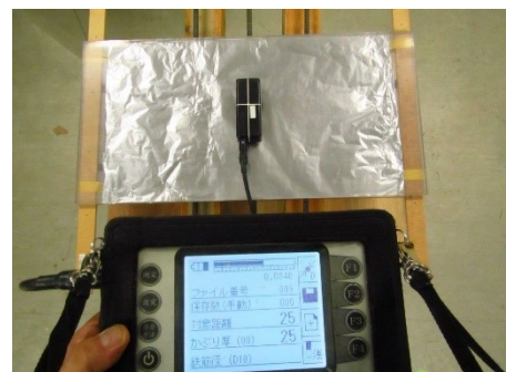
アクリル板の間にアルミ箔を配置
