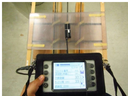
配筋の上にアクリル板のみ
