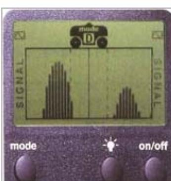
新たに追加された「ダイレクトモード」は、すべての障害物からの反応の強弱を棒グラフで表示します。障害物の幅・深さを探知する「モード」「モード2」と合わせて使用することで、より信頼度の高い探知結果を得ることができます。
