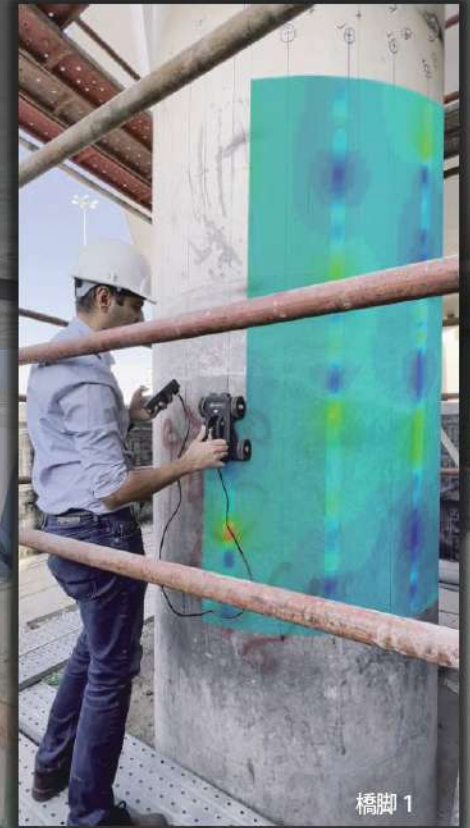
iCammによる主筋のスキャン
