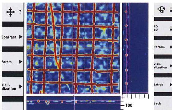
平面図はイメージスキャン箇所の埋設物位置を表示。任意に選んだX軸とY軸の断面図でかぶり厚さを素早く確認。
