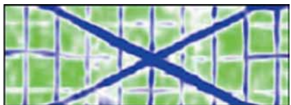
■ コンクリート打設後の探査結果
