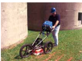
■ 400MHz アンテナを利用した鉄筋調査、配管探査：深度約 1.5m まで
