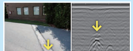
建物へと続く水路(埋設管)
