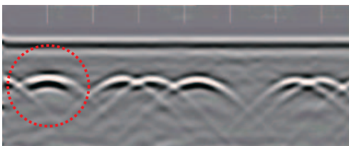
1600MHzアンテナを使用した測定例
