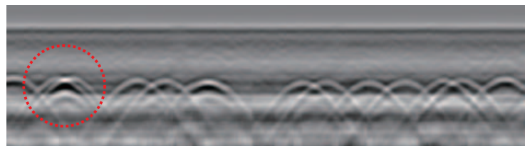
2600MHzアンテナを使用した測定例
